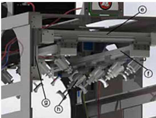
Rysunek 3. Dwumodułowy układ prowadnic A) moduł dolny: a – prowadnica dolna oś X, b – prowadnica dolna oś Y, c – prowadnica dolna oś Z, d – układ masujący dolny; B) moduł górny: e – prowadnica górna oś X, f – prowadnica górna oś Y, g – prowadnica górna oś Z, h – układ masujący górny
