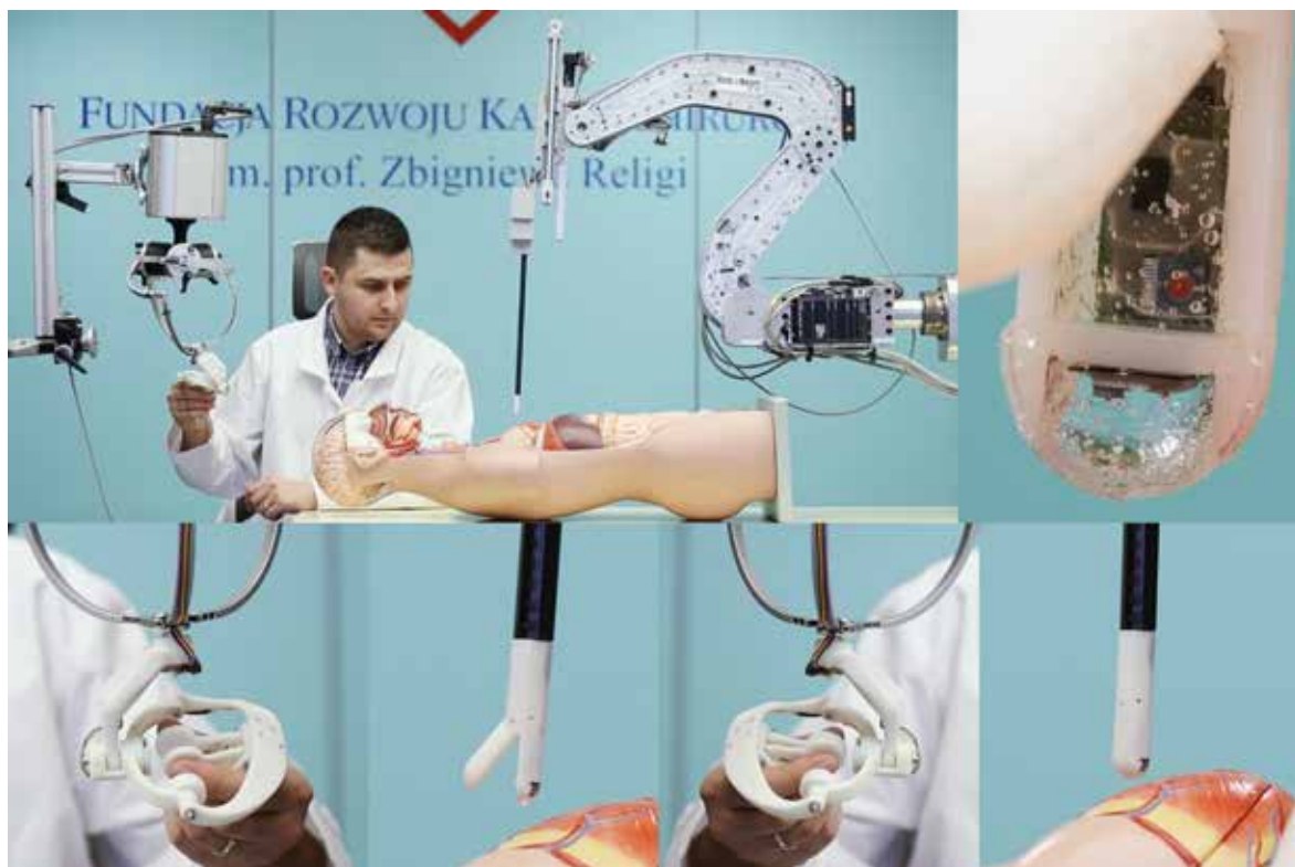
Rysunek 10. Demonstrator sterowania robotem ze sprzężeniem siłowym. Integracja robota Robin Heart z sensorycznym narzędziem robota
