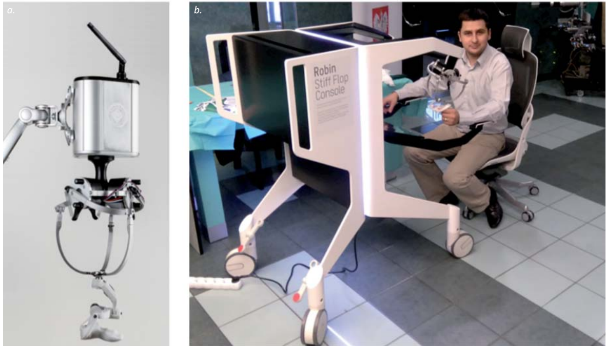
Rys. 7. Zadajnik RobinHand L a) wersja mobilna – komunikacja WiFi, b) konsola sterująca wraz z zaadaptowanym zadajnikiem (projekt Stiff Flop)
