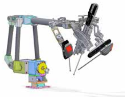
Rysunek 2. Model telemanipulatora Robin Heart Tele
